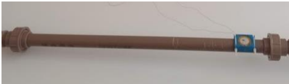
Figura 8. Tubo para monitoramento da estrutura juntamente com o sensor acoplado.
