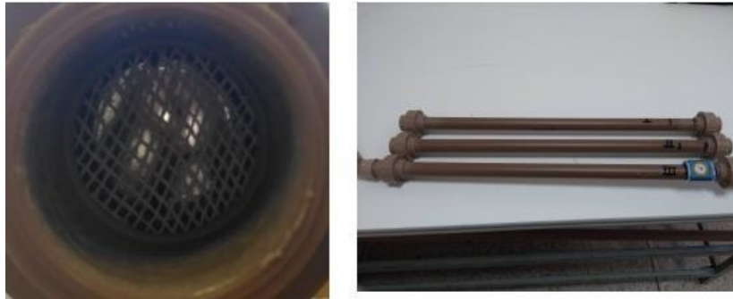
c) Filtro de tecido no tubo d) Tubos utilizados nos experimentos
