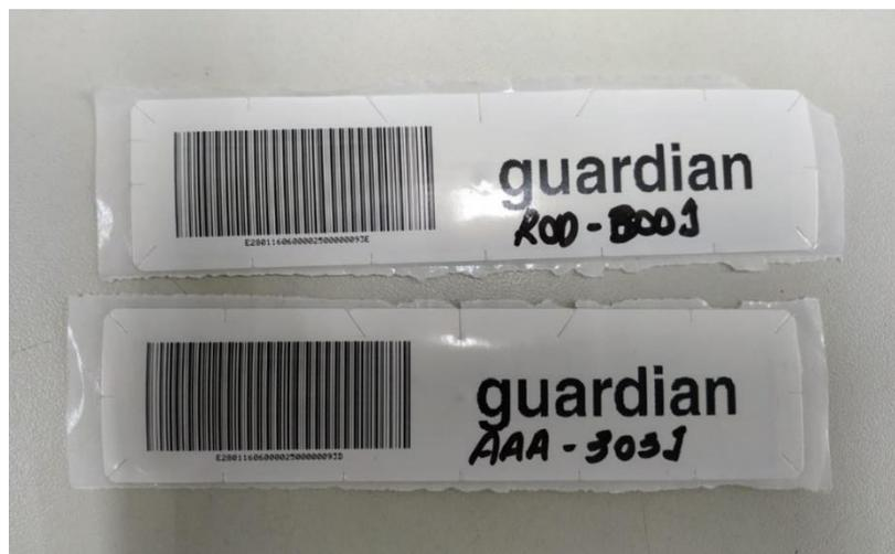
**Figura 3.** *Transponder* utilizado nos caminhões para comunicação e identificação nas balanças.
