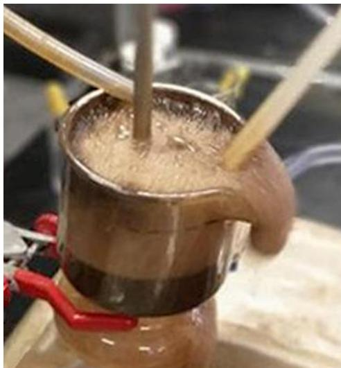
**FIGURA 1.** Célula de Fuerstenau, com espuma levemente escurecida, devido à presença de hematita.
