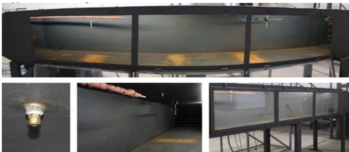
Figura 5. Seção de teste. (1) Sonda com aquecimento. (2) Sonda sem Aquecimento. (3) Bico de pulverização. (4) Janela de visualização.
