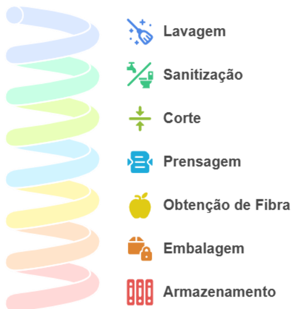
Figura 1. Fluxograma de obtenção da fibra do caju
