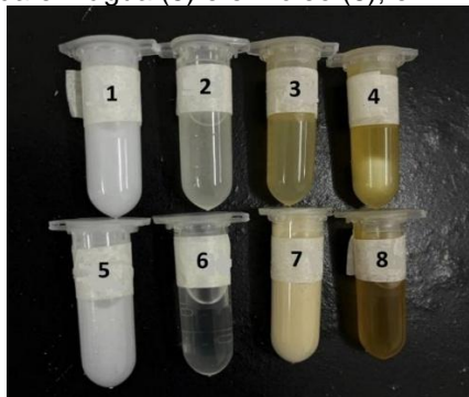
Figura 2: Teste de diluição: ME10-p diluída em água (1) e em óleo (2); ME10 diluída em água (3) e em óleo + barra magnética (4); ME20-p diluída em água (5) e em óleo (6); e ME20 diluída em água (7) e em óleo (8).
